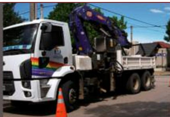
Encuentra aplicación en trabajos de movimiento de maquinaria, hormigón, contenedores, construcción de estructuras metálicas pesadas, carga y descarga de objetos voluminosos y pesados en general, etc.
