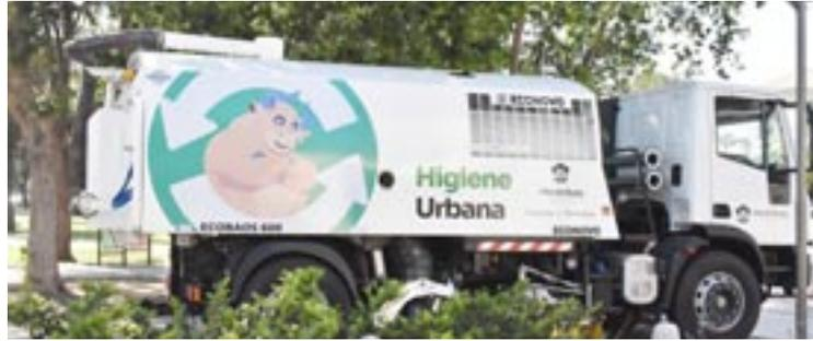
y nocturno de barrido y aspiración de residuos sólidos y líquidos sobre la vía pública, parques industriales, etc. con un ancho de trabajo de hasta 2 metros.
