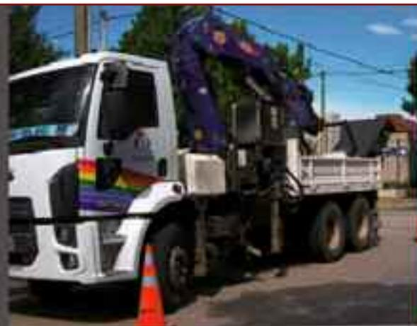
Encuentra aplicación en trabajos de movimiento de maquinaria, hormigón, contenedores, construcción de estructuras metálicas pesadas, carga y descarga de objetos voluminosos y pesados en general, etc.
